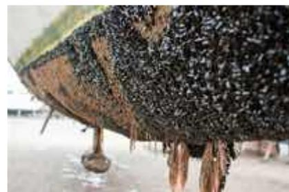
Le carénage préserve également le moteur car l'hélice et l'arbre d'hélice, même s'ils sont protégés par la peinture antifouling, finiront par recevoir une épaisseur de coquillages considérable si le carénage n'est pas fait régulièrement...
